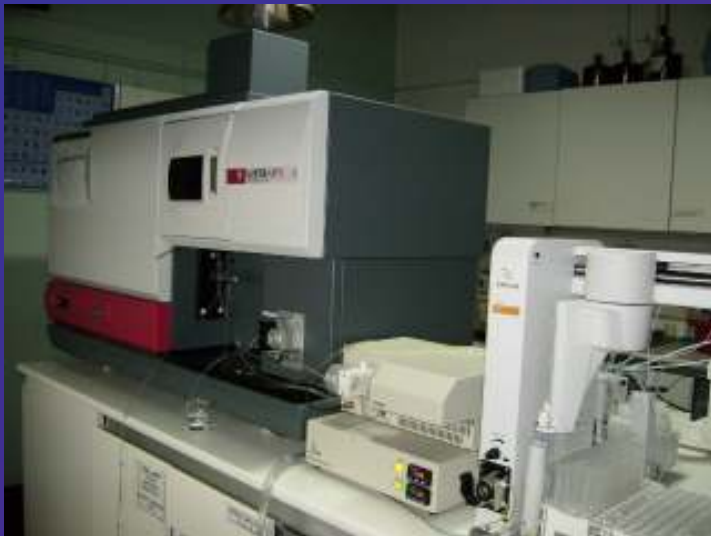
ICP-OES Espectrofotómetro de Emisión Atómica Acoplamiento de Plasma Inductivo Generador de Hidruros Autosampler Nebulizador ultrasónico
