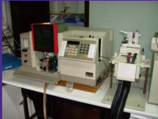
AA Espectrofotómetro de Absorción Atómica Con horno de grafito
